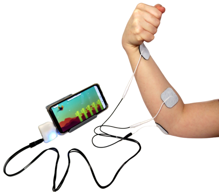
Ejemplo de colocación de electrodos para registro de flexores de muñeca y mano
